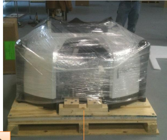
Versandbefestigung/-bolzen der Anlage.
